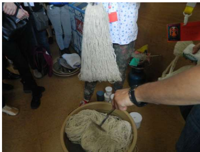
სურ: 5. შესაღები ძაფის შულოს ჩაშვება დასადედად ( კაუსტიკურ სოდაში)
