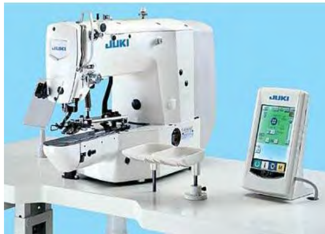
-ჩამავრების დასამზადებელი ნახევრად ავტომატური მანქანა
