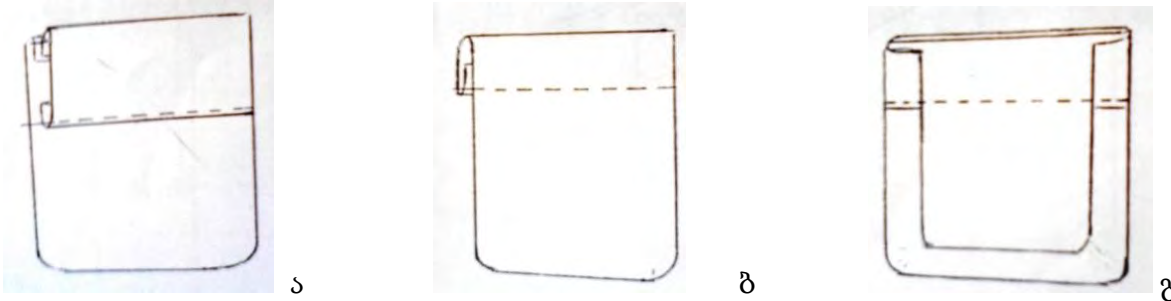
ნახ.7.4. ზედნადები ჯიბე: ა. ფურცლაკით, ბ. ფურცლაკის გარეშე. გ. მზა ზედნადები ჯიბე
